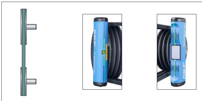
Рисунок 9 Соосность шкивов после правильно выполненной выверки
