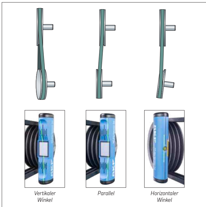
Abbildung 5 Zusammenfassung möglicher Fehlausrichtungen
